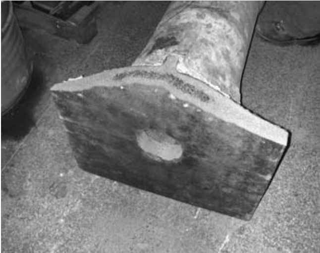
Obr. 6 – Porušení patní desky při zkoušce za běžné teploty
