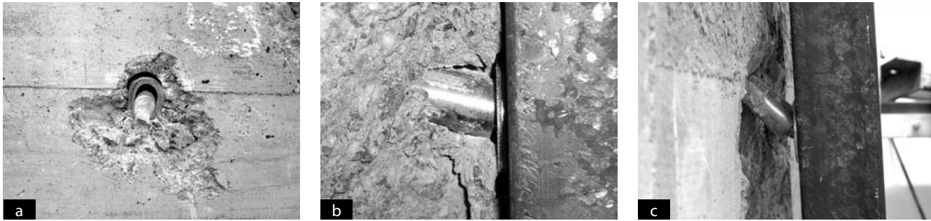
Obr. 3 – Ilustrace mechanismů porušení rozpěrných kotvek namáhaných smykem
