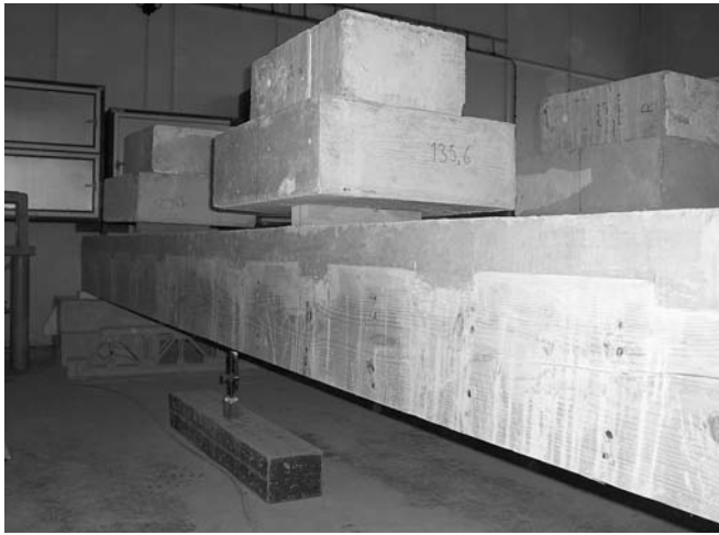
Obr. 3 – Spůsob zatažení skúšobných nosníkov
