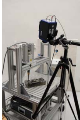
Obr. 3. Ultrazvukový systém budenia a termokamera FLIR SC7500
